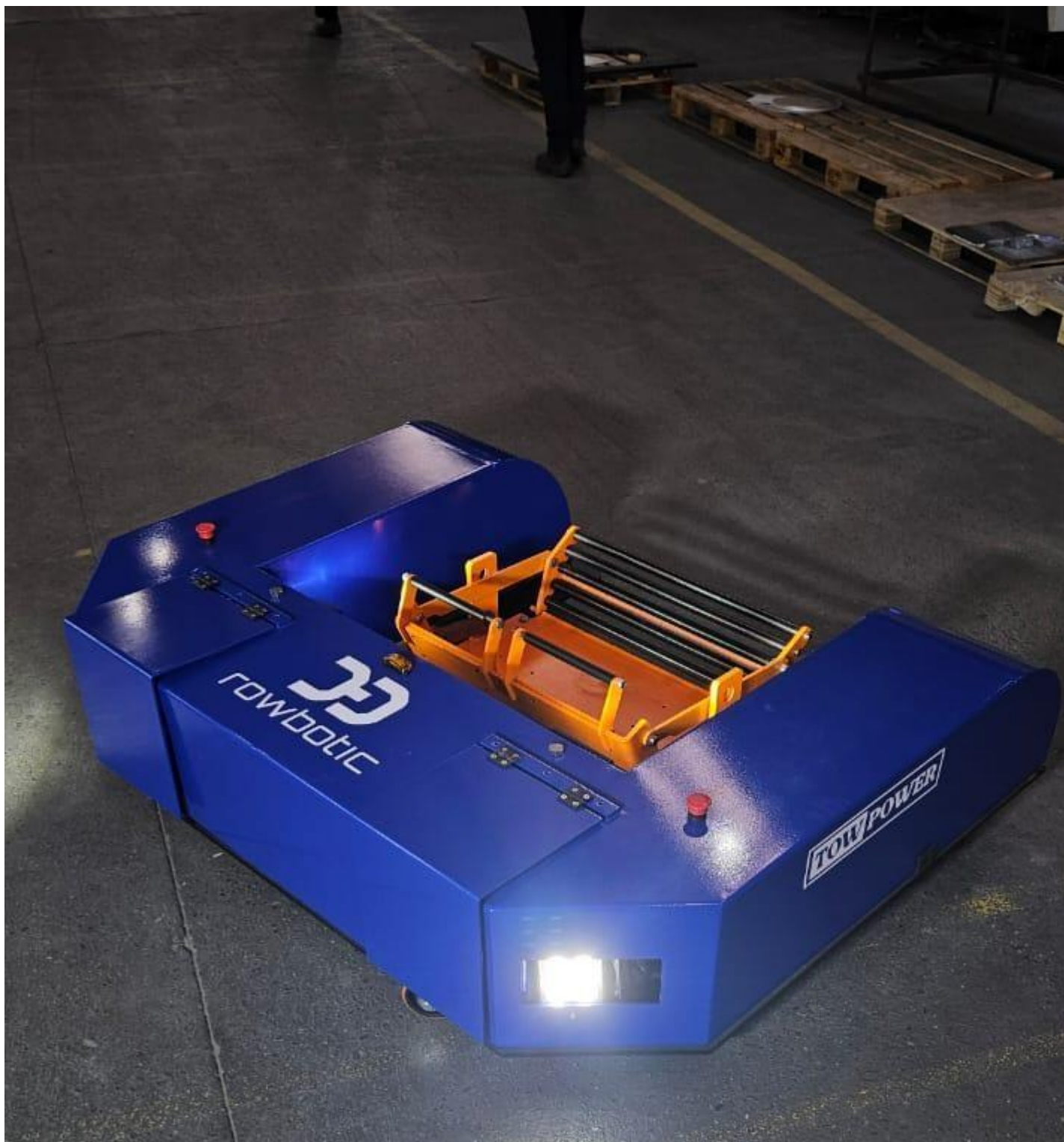
Figura 1: TowPower TP50 - Visão geral do equipamento mostrando o chassi azul, bandeja laranja e sistemas de iluminação
