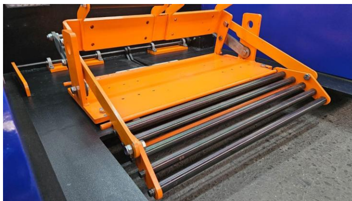
Figura 6: Bandeja destravada. Ao lado é possível ver a manopla para destravamento manual.
