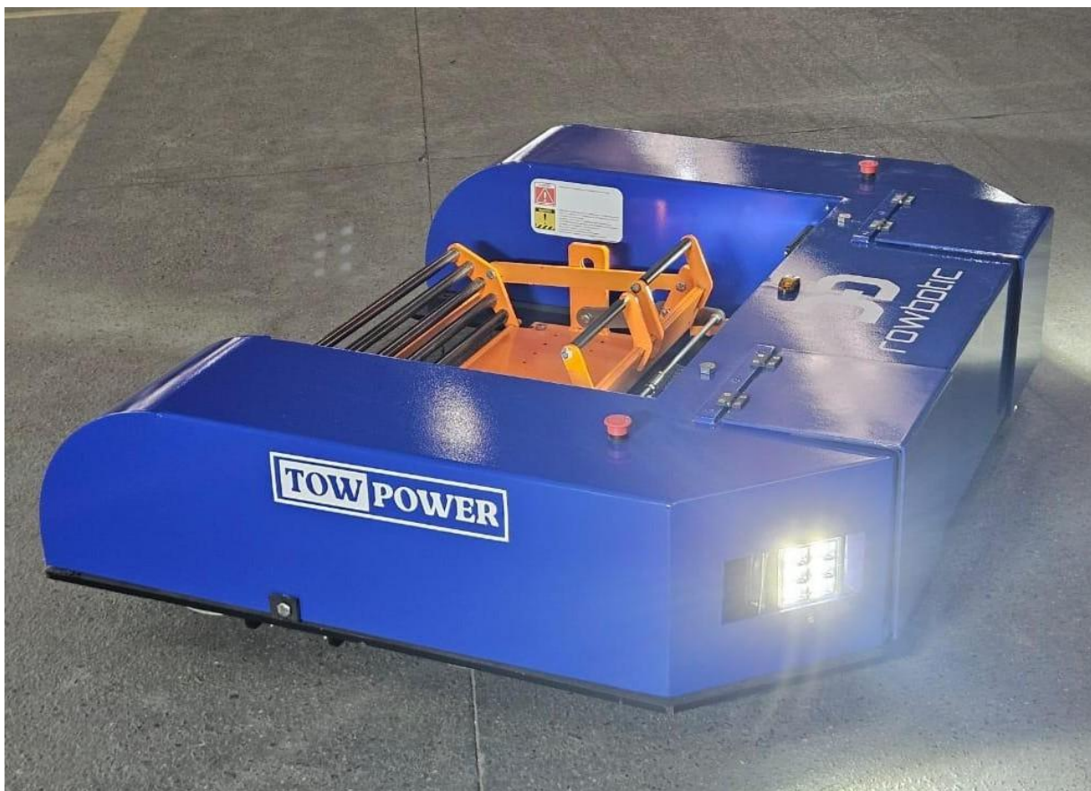
Figura 4: Detalhe da bandeja com sistema de roletes e mecanismo de travamento
