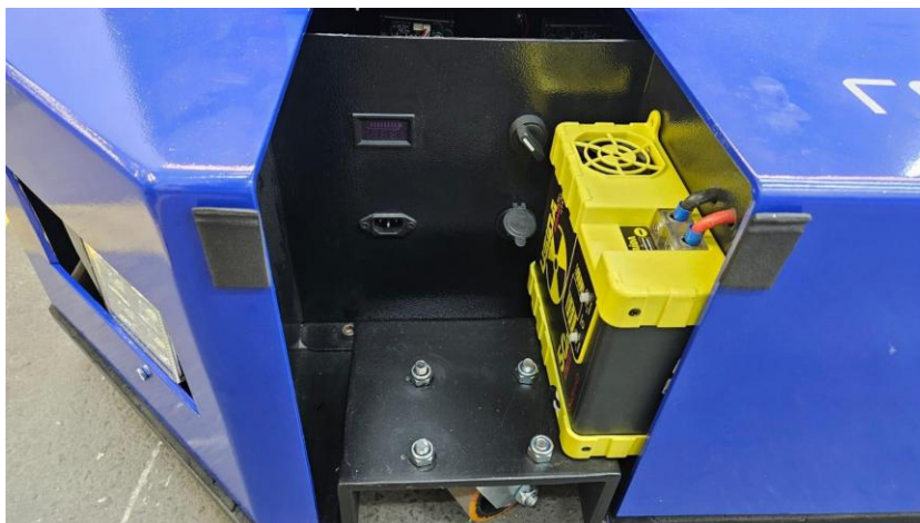
Figura 7: Painel de comando com voltímetro, chave seletora On/Off, entrada de energia para carregamento e porta USB para carregamento do controle remoto.
