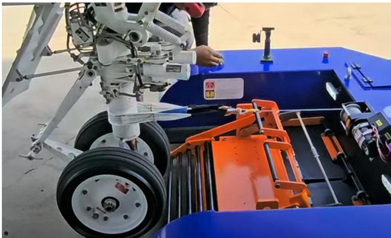
Figura 10: Cabo do Guincho tensionado.
